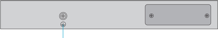
Point de Mise à la Terre
